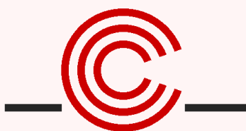
ŠPATNĚ - SVINUTÝ KABEL
