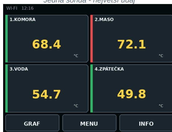
Tři/čtyři sondy - uspořádání 2 x 2
