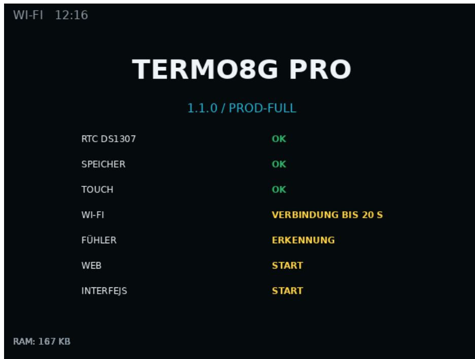
Startbildschirm - Darstellung der Startstufen von Firmware 1.1.0.
